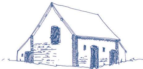
Élargissement de la maison par l'adjonction d'un appentis en prolongement du volume principal. L'élargissement doit être de faible profondeur par rapport au bâtiment d'origine et de hauteur minimale nécessaire à l'habitabilité.
